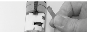
Kuva (9) Narusuoja ja kantonarun kiinnitys
