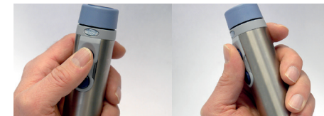
Rysunek (13) Obsługa przycisków poprzez przechylenie kciuka
