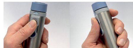
Obrázok (13) Ovládanie tlačidiel nakláňaním palca
