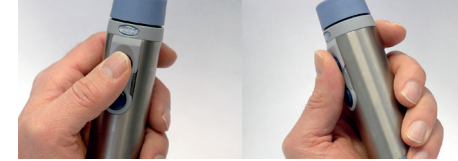
Figure 13) Utilisation des touches par inclinaison du pouce
