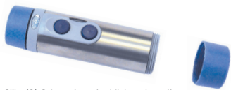
Slika (2) Odstranjevanje držala za baterije
